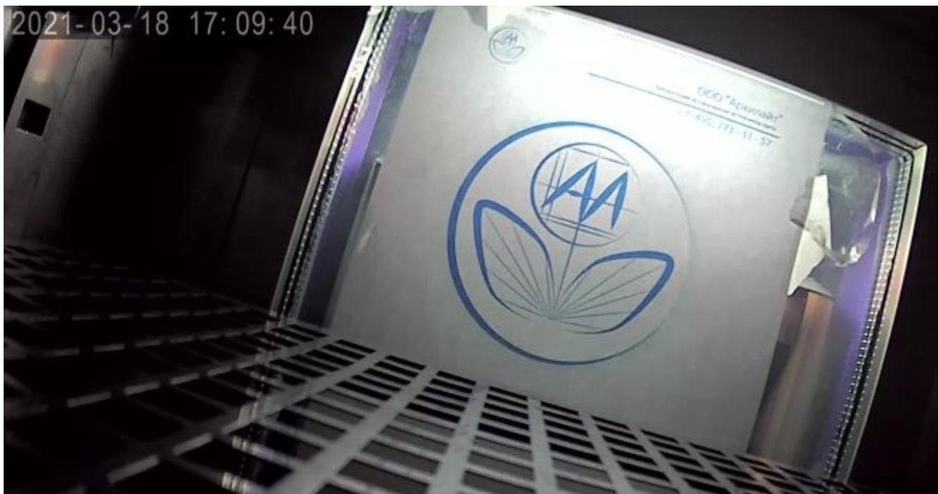
**Заключение.** Видеокамера работоспособна при температуре окружающей среды –25°С
